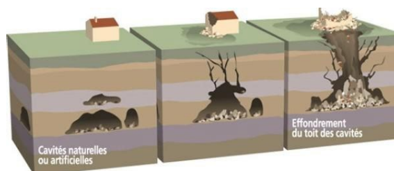
Figure 26 : Le risque d'effondrement des cavités
